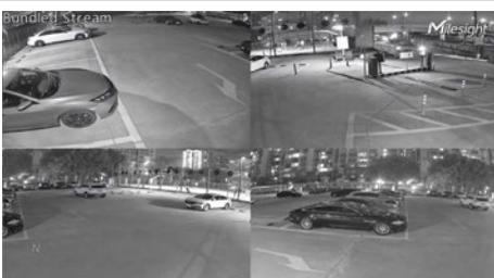
Bei schlechten Lichtbedingungen, zum Beispiel nachts, schaltet die Kamera automatisch in den Schwarz/Weiß-Betrieb um. Die Sicht wird zusätzlich durch die integrierte 360 Grad Infrarotbeleuchtung unterstützt.
